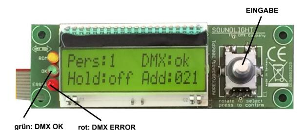
Die Display-Anzeige richtet sich nach der Einstellung des Host-Decoders und ändert sich, wenn dieser auf Subdevice-Modus konfiguriert ist (diese Einstellung ist lediglich über einen RDM Controller am Host-Decoder möglich).
